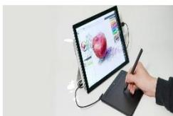
Dispositivo que digitaliza os movimentos de uma caneta óptica em uma superfície especial. Muito utilizado no setor de artes gráficas e engenharia. Na realidade existem vários tipos de mesas digitalizadoras, para os mais variados fins.
